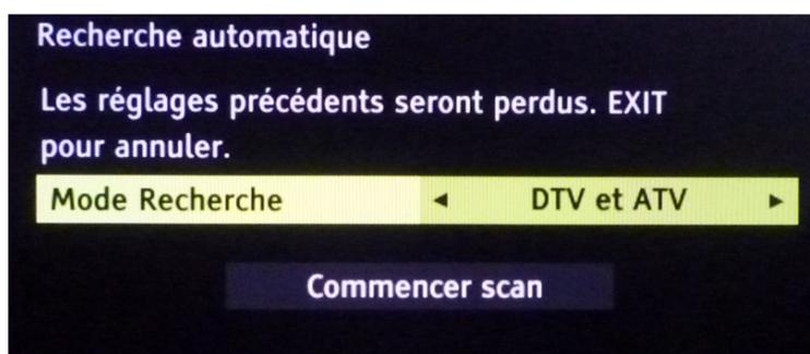
5. Sélectionnez, sous **Mode Recherche**, en utilisant les flèches de direction sur la télécommande pour se déplacer, le choix « **DTV et ATV** ».
